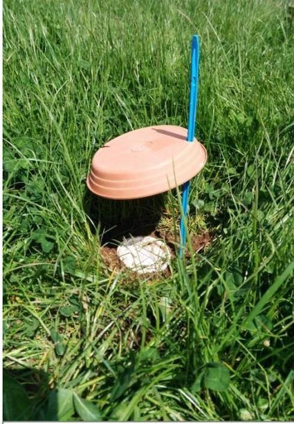
Figure 9: Piège pot Barber avec coupelle de protection pour la pluie (L. Albert , 2014).
