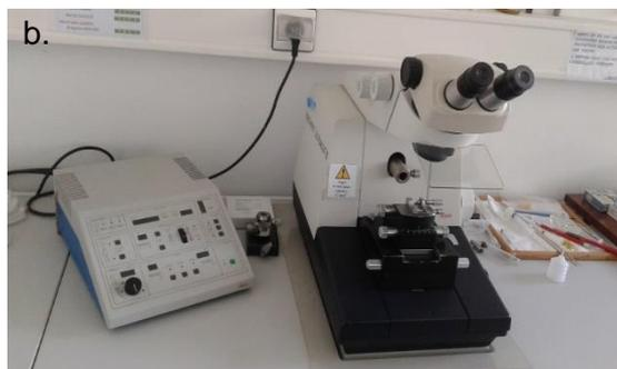
Figure 14 : a. Microscope électronique à transmission FEI Technai spirit ; b. l'Ultra-microtome Reichert Ultracut S.
