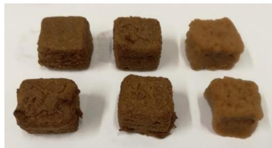
Figure 7 Cubes de marc de pomme réalisés par une imprimante 3D. Source : AlpBioEco (2019)
