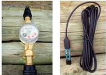
**Compteur d'eau & sonde d'humidité du sol**
