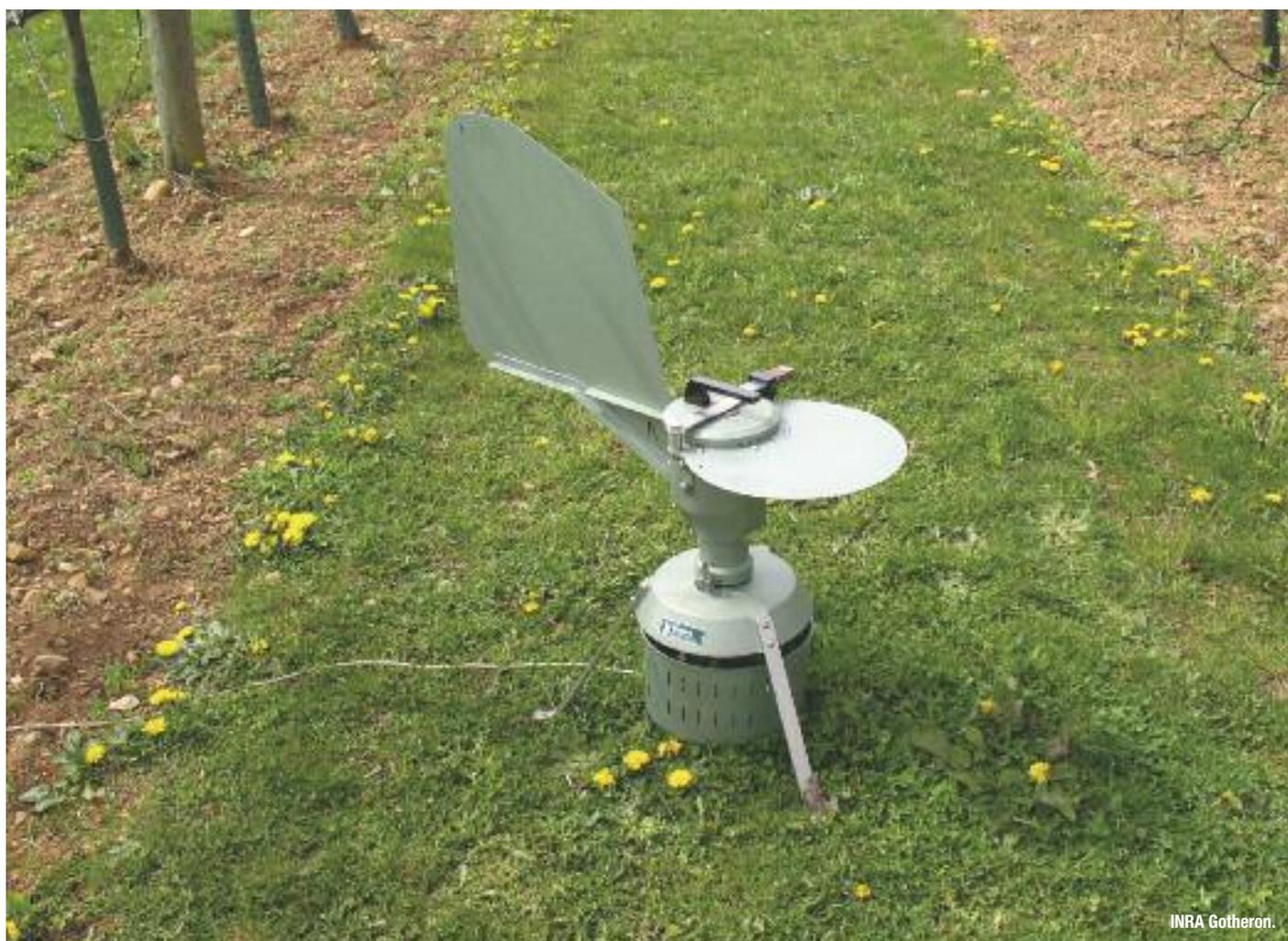
Piège à projections d'ascospores de Tavelure BURKARD ®
