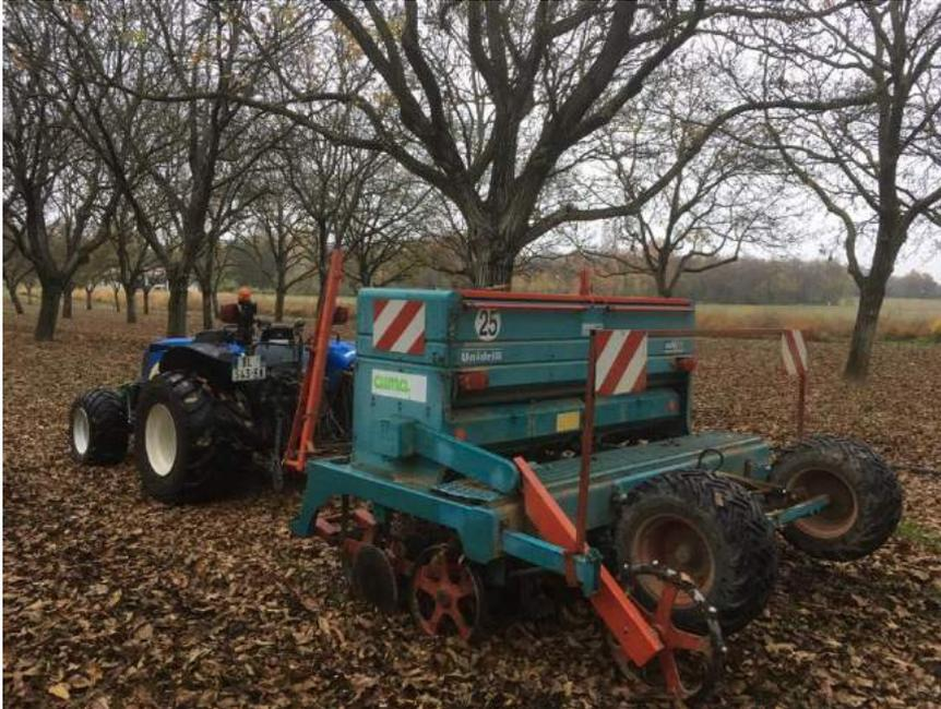
**Semoir** de semis direct à disque pour les semis de couverts d'hiver à contre-cycle par rapport à la feuillaison du noyer.
