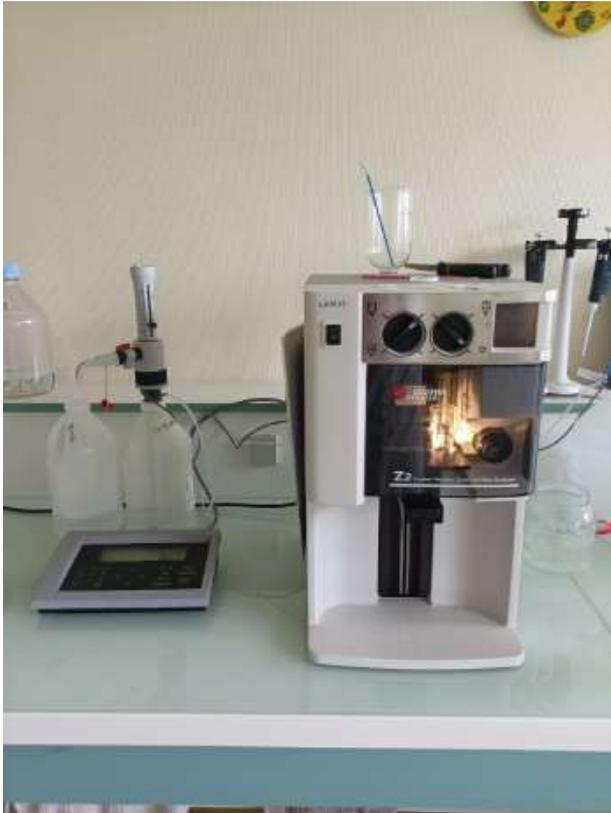
*Figure 11 : Compteur de particules (coulter counter)
